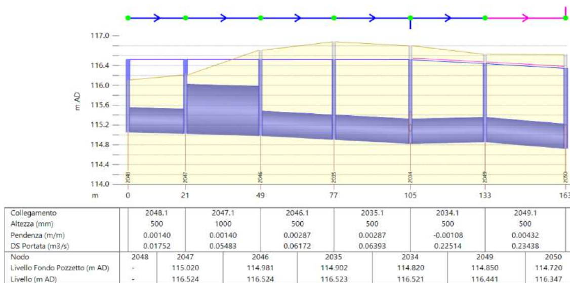
Figura 25 – Profilo idraulico della rete mista di via Venezia allo stato di progetto
