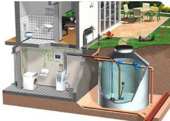
Figura 22 – Esempi di applicazione di vasche di laminazione sotterranee per piccole e medie estensioni, strutturabili sia per la sola laminazione con scarico in sistema di infiltrazione, sia per il riuso (tratte dal sito http://www.3ptechnik.it/it/home.html )
